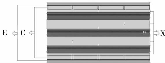
图 1 单壳程折流杆换热器流路干涉模型
