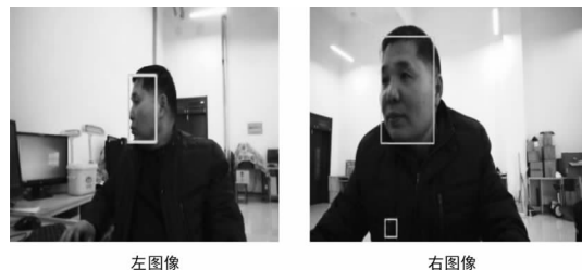
图 4 利用深度学习的坐标回归人脸检测图
